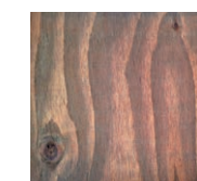
内側 構造用針葉樹合板 + 木材保護着色処理 (全色共通)
